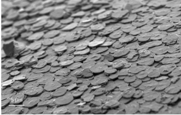
figure 10 - nacre de la coquille d' Haliotis tuberculata la nacre de la coquille d' H. tuberculata , correspond à l'empilement très régulier de plaquettes d'aragonite.
