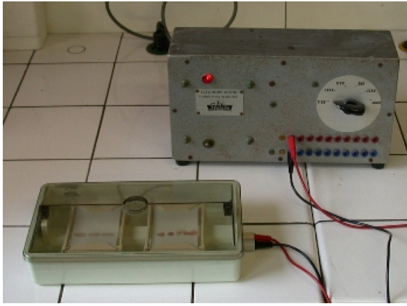
Figure 4 - Cuve et générateur pendant la migration
