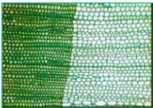
Figure 4 : Observations microscopiques d'une coupe transversale de bois de pin à la limite de deux cernes
