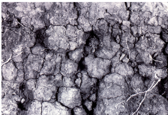
figure 11 - macrostructure montrant des agrégats polyédriques en place, laissant apparaître les vides entre les agrégats
