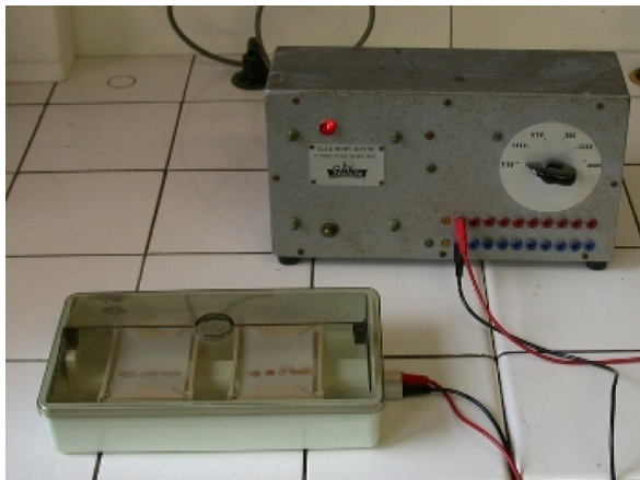
figure 4 - cuve et générateur pendant la migration
