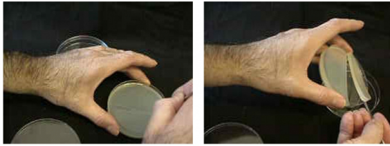
figure 3 - protocole de fabrication de demi-boîtes de gélose en deux étapes
